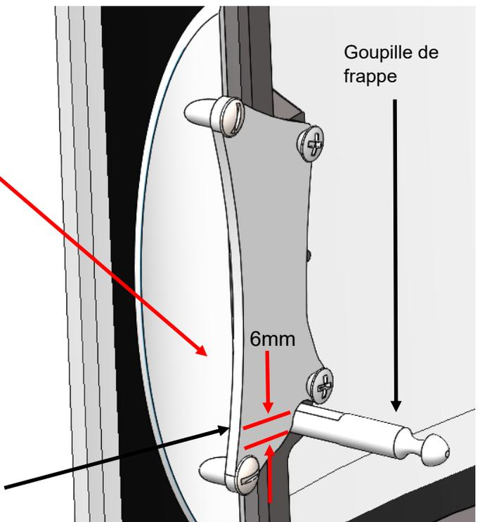
Plats de la goupille de frappe. Utiliser une clé de 6 mm pour le démontage.
