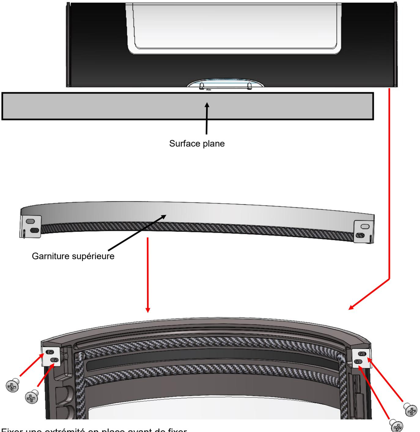
Fixer une extrémité en place avant de fixer l'autre extrémité
