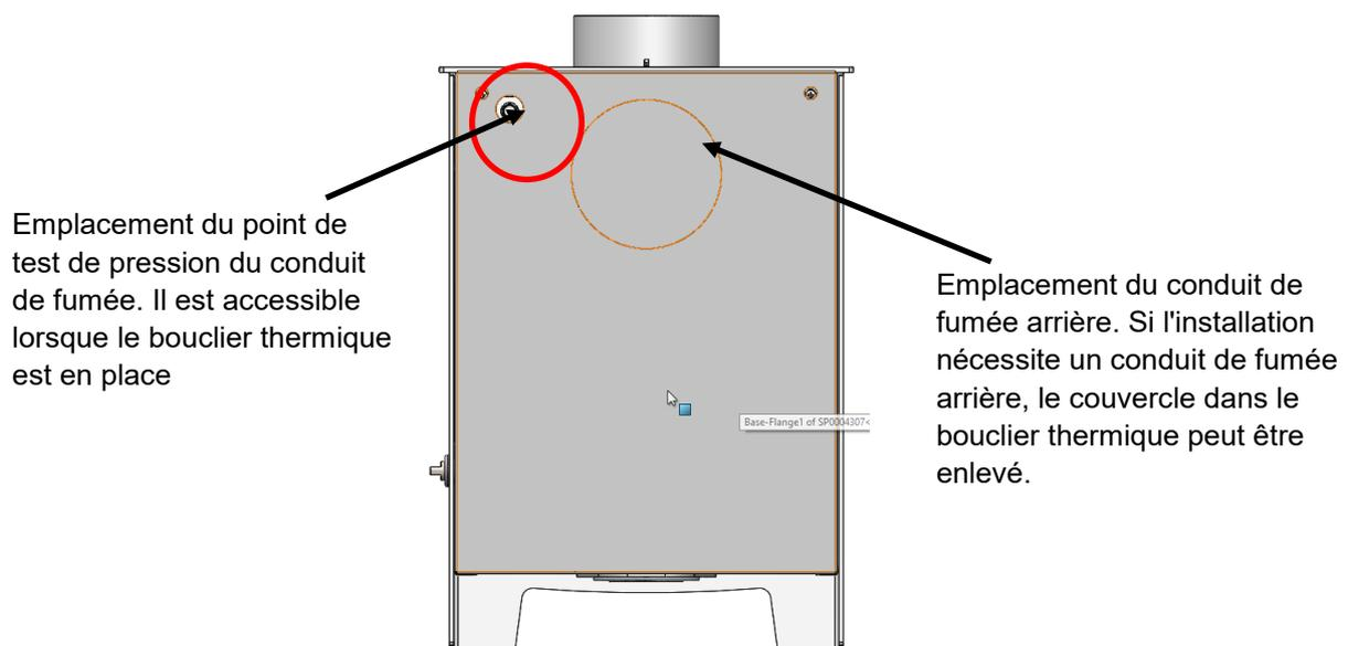
Figure 4. Disposition de l'écran thermique arrière
