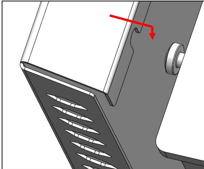
Figure 3. Emplacement de l'écran thermique
