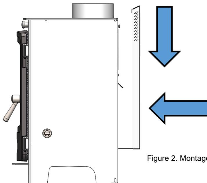
**Étape 3 :** S'assurer que le bouclier thermique est entièrement placé dans la fente découpée à l'intérieur du bouclier thermique (des deux côtés - gauche et droite).
